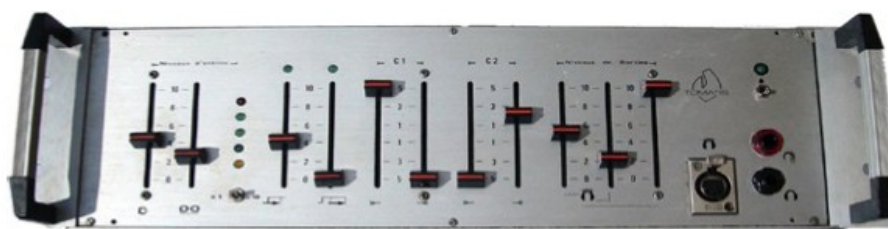
Oreille électronique de 1980 — entrées micro et magnétophone, retard, précession, bascule électronique, C1, C2, conduction aérienne, osseuse et équilibrée. © Christophe Besson
