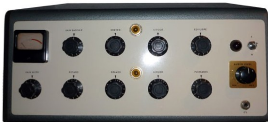
Oreille électronique de 1955 — entrée micro, retard, bascule électronique, C1, C2, conduction aérienne et équilibre. © Christophe Besson
